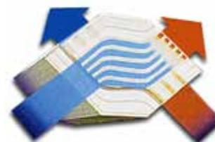
Il medesimo scambiatore di calore ad alta efficienza viene mostrato in condizioni di bilanciamento (identiche portate) e di non bilanciamento (100 m<sup>3</sup>/h in immissione e solo 80 m<sup>3</sup>/h in espulsione). Quando le portate al recuperatore di calore sono sbilanciate e quindi diverse tra loro, il flusso con portata inferiore non ha capacità termica sufficiente per ricevere tutto il calore possibile contenuto dal flusso con portata superiore.
