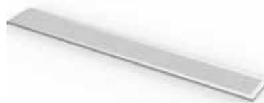
La massima salubrità dell'aria è perseguita anche grazie allo specifico filtro in poliestere rinforzato e racchiuso in una rete metallica di supporto, classe di filtrazione G4 secondo EN 779, da posizionare sui terminali di ripresa o di mandata per preservare la pulizia dei condotti nel tempo. Per bocchette Linea e Plana.
