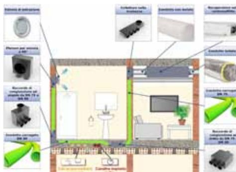
Il diametro 75 mm consente di convogliare sino a 34 m<sup>3</sup>/h di aria per singolo condotto mantenendo una ridotta velocit  e un'elevata silenziosit . Il diametro 50 mm   utilizzato per ridurre al minimo gli ingombri dell'impianto di distribuzione dell'aria, ad esempio per la posa all'interno dei sottofondi in ristrutturazioni o in particolari condizioni di cantiere (aggiramento scarichi sanitari o altri ostacoli).
