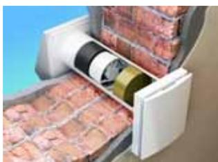
La ventilazione meccanica energetica puntuale avviene stanza per stanza: un dispositivo indipendente di recupero energetico e ventilazione può essere installato ad incasso nella parete perimetrale di ciascuna stanza, e non è necessaria, quindi, alcuna rete di distribuzione dell'aria
