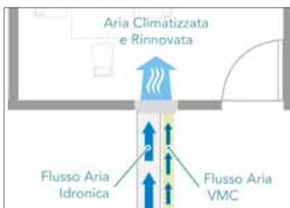
Ideal Clima sfrutta il principio della "confluenza alla bocchetta": le portate aria scorrono in condotti separati fino al plenum. Grazie a questo principio le portate aria non vengono modificate, ad esempio dalla variazione della velocità del terminale idronico.
