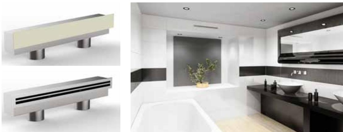
Il plenum per bocchette Linea e Plana è adatto ad essere impiegato sia in immissione che in estrazione. E' dotato di due attacchi per condotto Treo flessibile DN 75, con linguette di fissaggio plug-in e di valvole a farfalla per la regolazione della portata. Con attacchi magnetici predisposti per il posizionamento del filtro aria.
