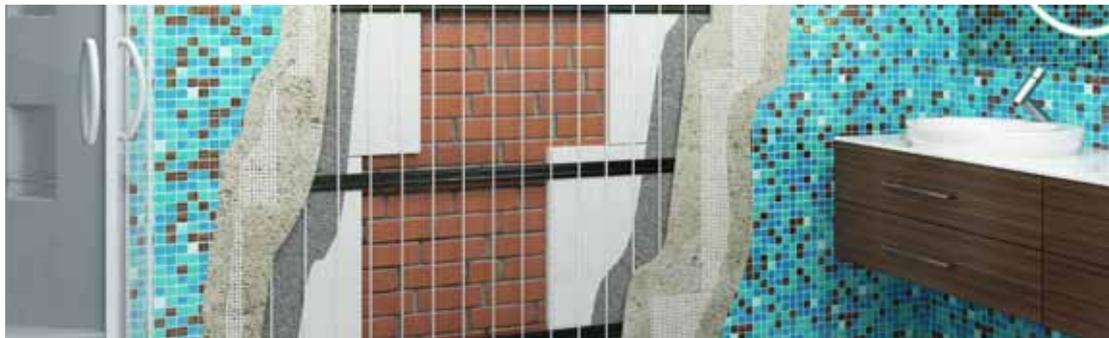
Il sistema è costituito da un tubo da 10x1,3 mm con barriera antiossigeno EVOH e dal binario di posa specifico per parete.
