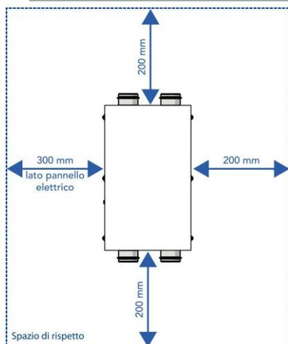
Come indicato in figura, lasciare spazi liberi per l'accesso in occasione di manutenzione. In presenza di controsoffitto, installare pannelli mobili che permettano di aprire il recuperatore verso il basso e di rimuovere l'intera unità in caso di guasto.
