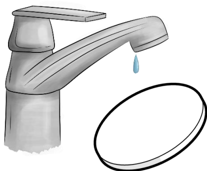
Pulire i filtri con acqua e lasciarli asciugare. I filtri devono essere reinseriti solo completamente asciutti.
