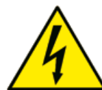
Presenza tensione elettrica pericolosa
